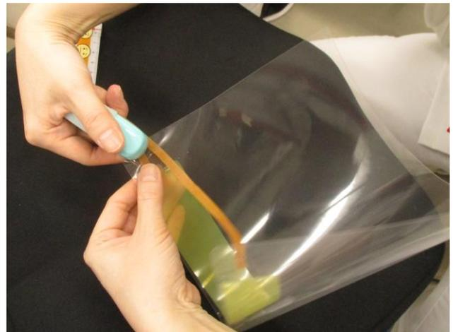
3. つけるときに呼気の水蒸気が上に抜けるよう1 cmの隙間ができていれば完成です
